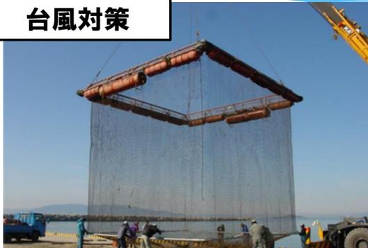
10m角型**浮沈式鉄生簀**
