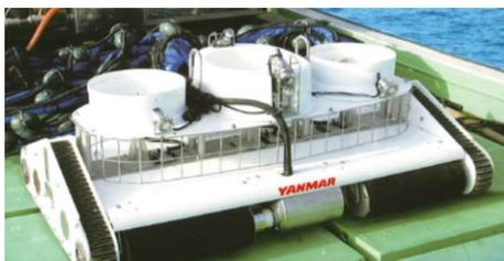
3連式大型網洗浄ロボット
