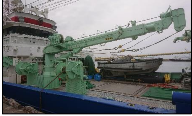
作業艇の搭載状態
