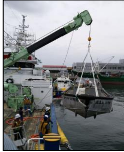
作業艇の昇降作業
