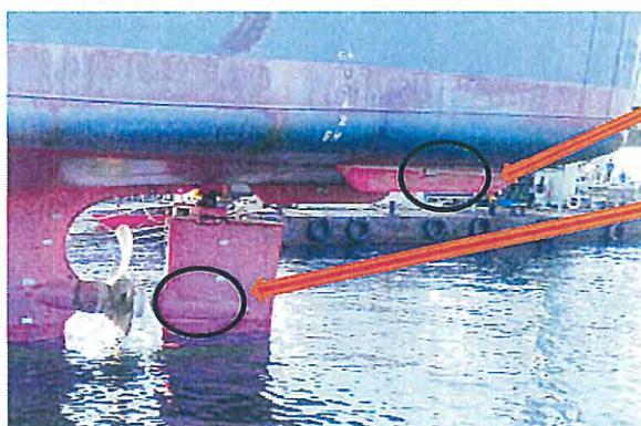
船尾バルブとラダーポッド付舵板の実例
