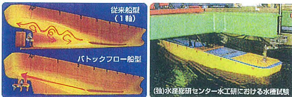
船尾バルブとラダーポッド付舵板の実例
