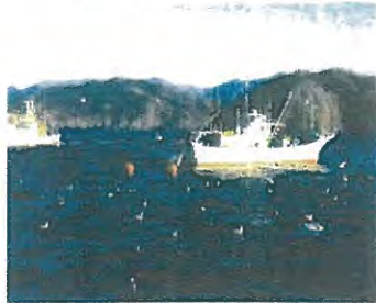
②曳き網が設定水深に敷設される (浮標が縦になる)
