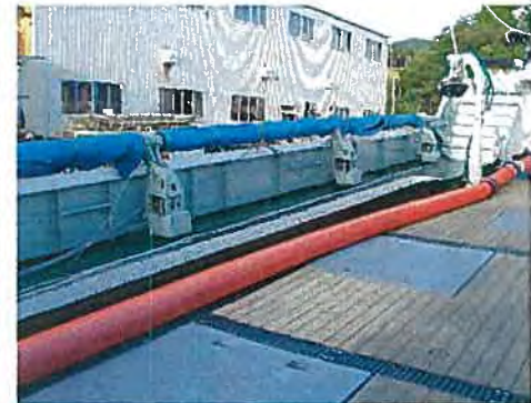
上甲板上にミニボールロー ラー(網捌機)を設置
