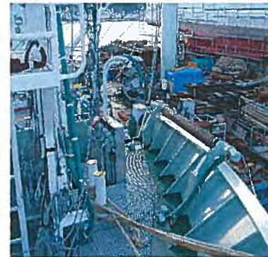
船首甲板上にサイド ローラーを設置
