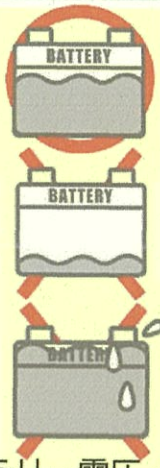
バッテリー電圧・液量 端子・ケーブル確認
