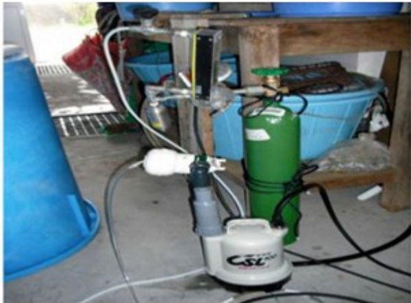
図5 試作したCO 2 マイクロバブル発生装置とその流路
