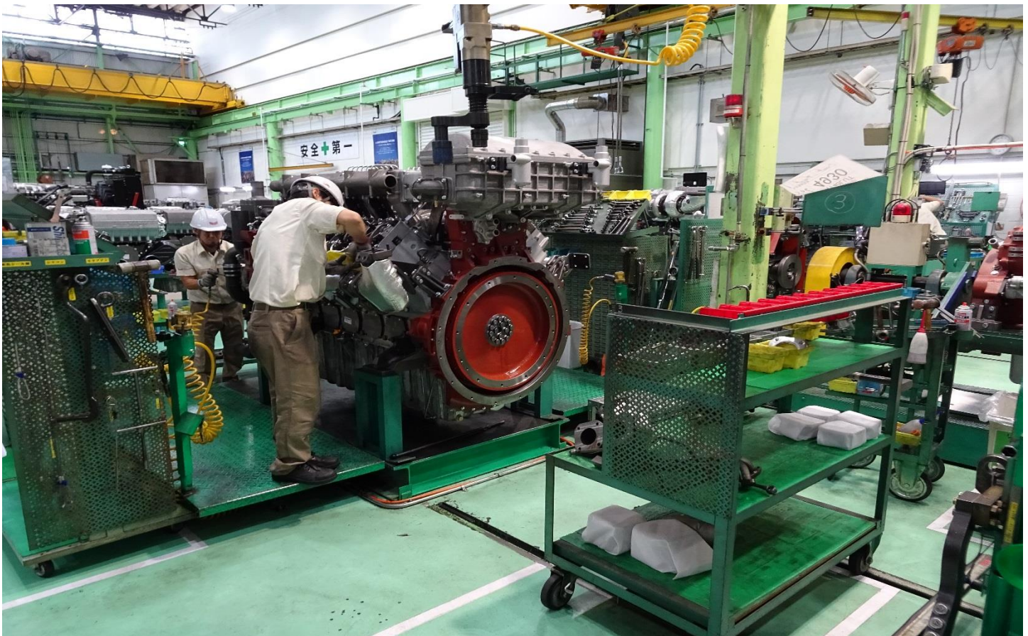
※船舶用ディーゼルエンジンの組立工程
