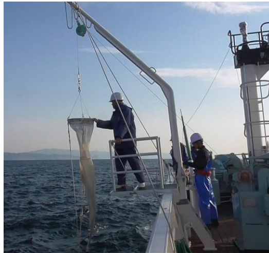
図 13 プランクトンネットによる卵稚仔の採取
